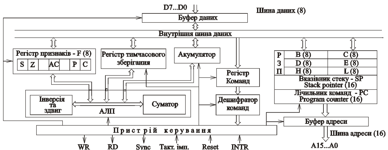
Рис. 1. Архітектура мікропроцесора серії KP580
